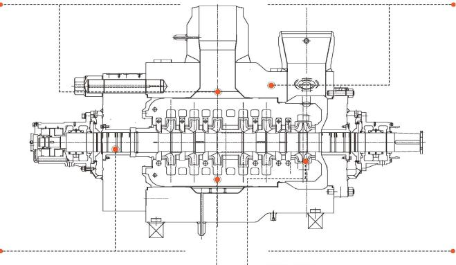
轴封选择:独有的迷宫密封外加注入低温凝结水保证了可 靠运行、维修最少和磨损极低。对于较低要求的场合,也可 以使用传统的填料密封。此外对于锅炉给水,推荐使用机械 密封。
