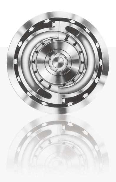
通过双蜗壳结构,液流被分流到两个独立对称分布的流道中,大小相等的径向力相互抵消而使泵轴不会产生弯曲和扭矩。在任意流量下,由于叶轮的对称分布,轴向力也被自动抵消。由于内壳体采用了双蜗壳设计,转子部件采用了对称布置叶轮,实现了径向力和轴向力自动平衡。
