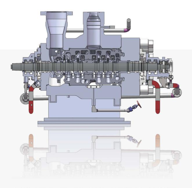
当需要对内部检修维护时,打开外筒体泵盖、装上拆装架、拉出内壳体后吊起内壳体的上壳体,就可以从壳体中拿出转子 部件,主管路和驱动机都不需要拆动。
